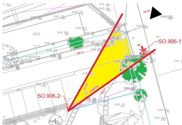
Obrázek.: Znázorněno umístění a zorný úhel kamery, podrobnosti jsou uvedeny ve výkresu D.1.9.SO.906.2.1.
